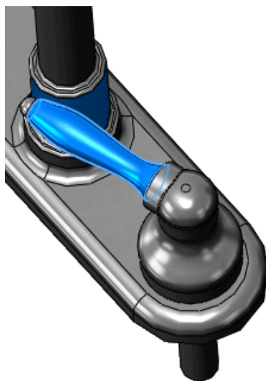
Ensamblaje del grifo con Detección de colisión y la opción Detener al colisionar activada
